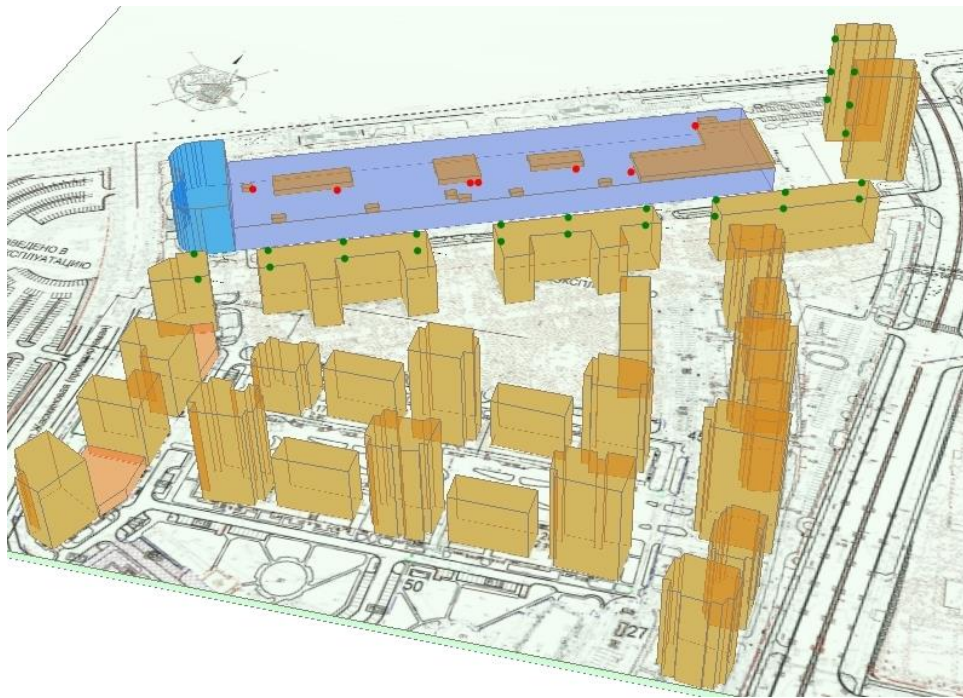
3D-модель местности построенная в программе «АРМ Акустика 3D»
