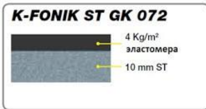
Структура материала по типу K-FONIK ST GK 072
